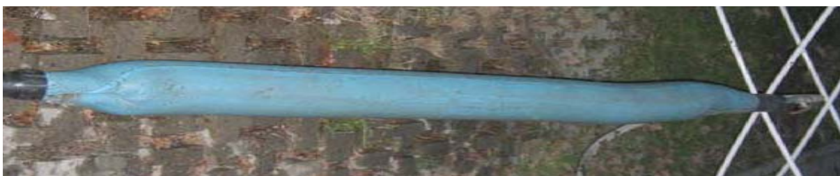
Figura 7 – Elementos VTR tubulares con geotextil externo para controlar el volumen de inyección y la adherencia
