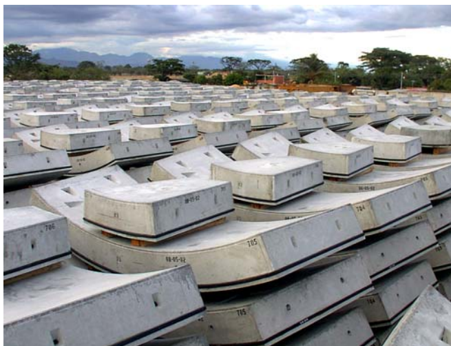
prefabricados para el Metro de Valencia en Venezuela.
