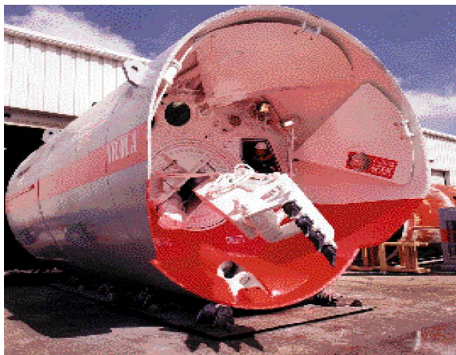
Figura 12. Escudo de brazo mecánico en aire comprimido con compuertas mecánicas.
