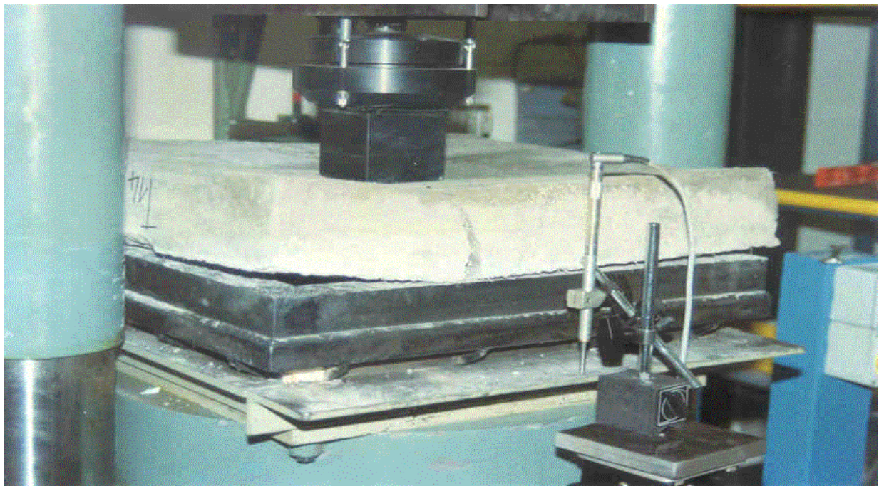
FOTO 2 – Ensayo de tenacidad (SNCF 89)
