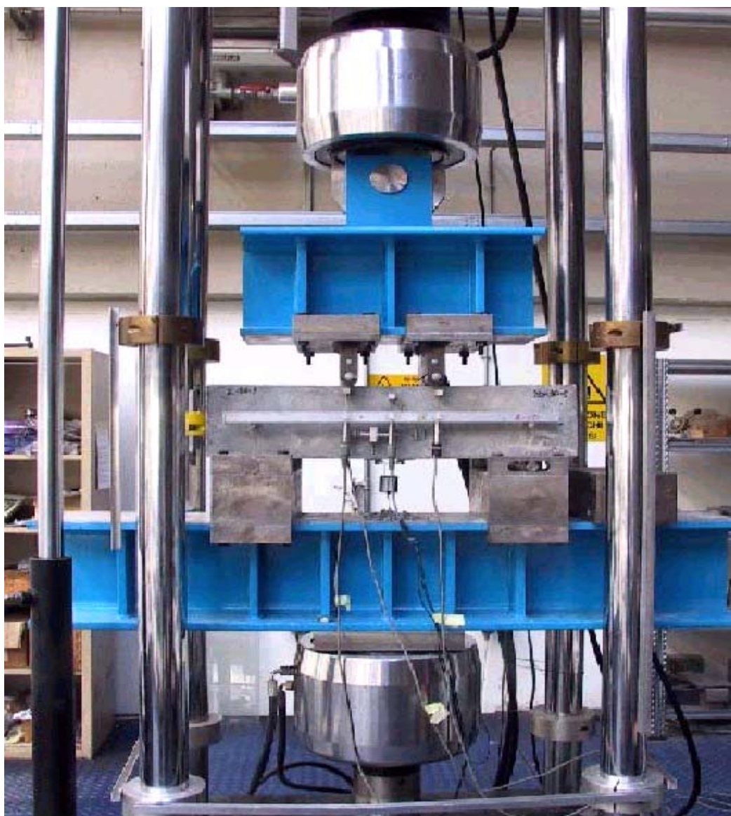
FOTO 1 – Ensayo de viga a flexión
