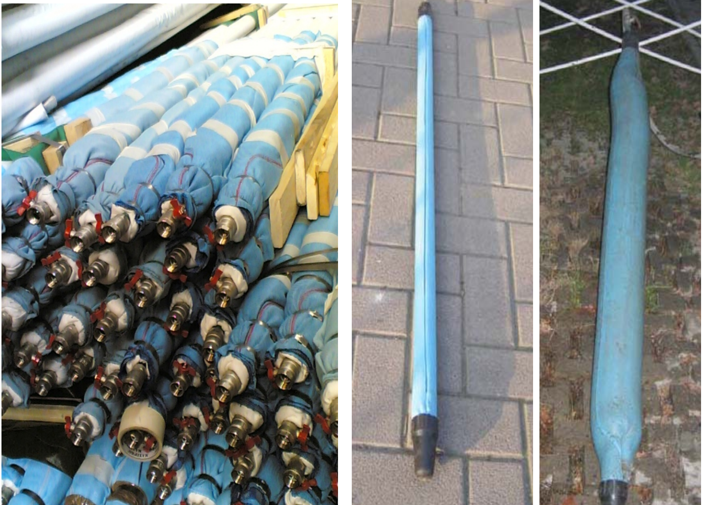
Fig. 10b Elementos VTR tubulares con geotextil externo para controlar el volumen de inyección y la adherencia
