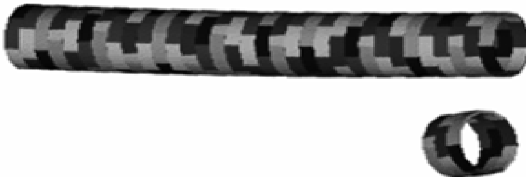
Figura 8: Esquema la secuencia de anillos universales en curva de radio mínimo ( R=300m )
